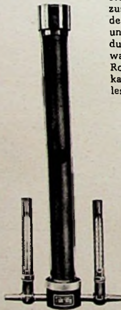
Bild 1. Hochleistungs-Schichtwiderstand für maximal 20 kW Belastung mit Wasserkühlung
