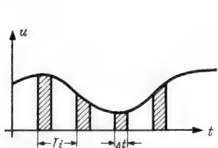
Bild 45. Schematische Darstellung der Pulsamplitudenmodulation
